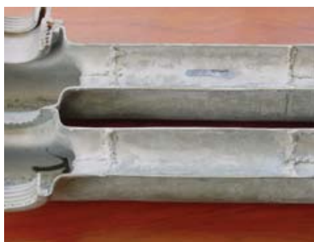
радиатор после 2000 часов Salt Spray тестирования
